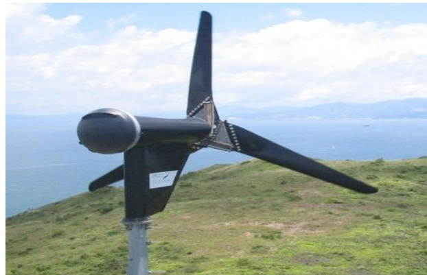
Proven11 Wind Turbine 6Kw
